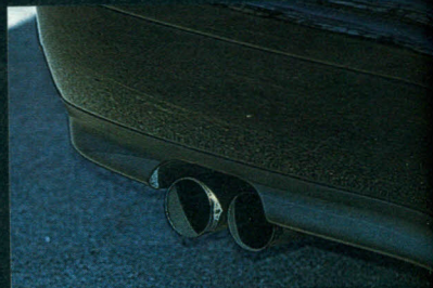
Unspektakuläres Ende einer Eigenbau-Edelstahlanlage mit Rennkat. Um so spektakulärer der Sound!
